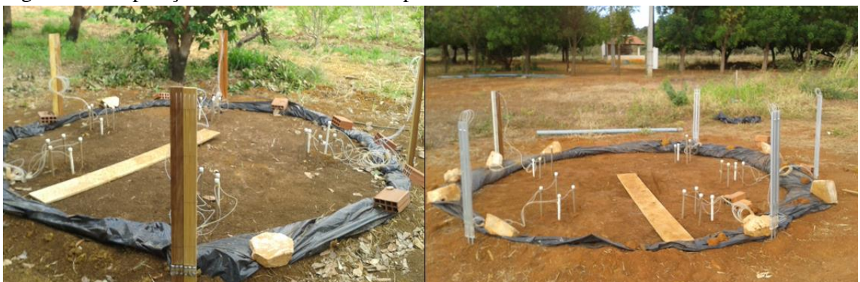
Figura 4 – Disposição dos tensiômetros nos perfis instantâneos.
