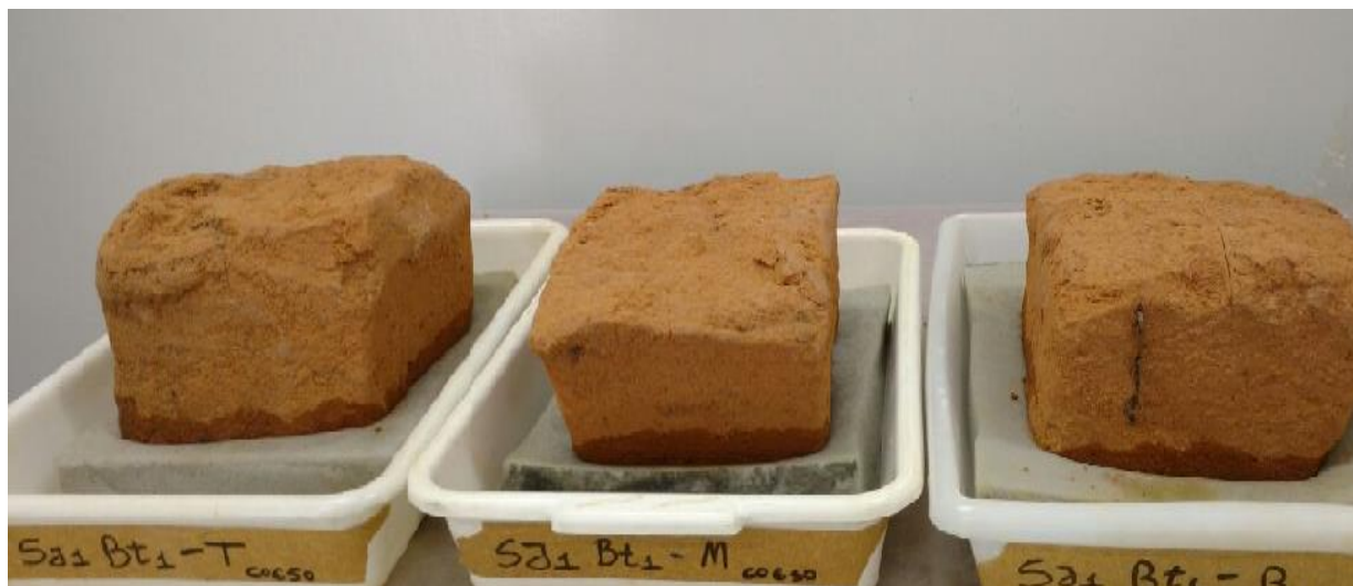
Figura 2. Detalhe do umedecimento dos blocos em laboratório.
