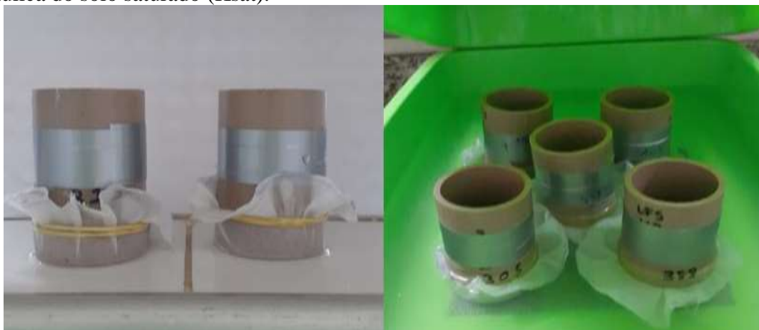
Figura 12. Cilindros com dimensão de 4,3 x 5cm utilizados na avaliação da condutividade hidráulica do solo saturado ( K_{sat} ).
