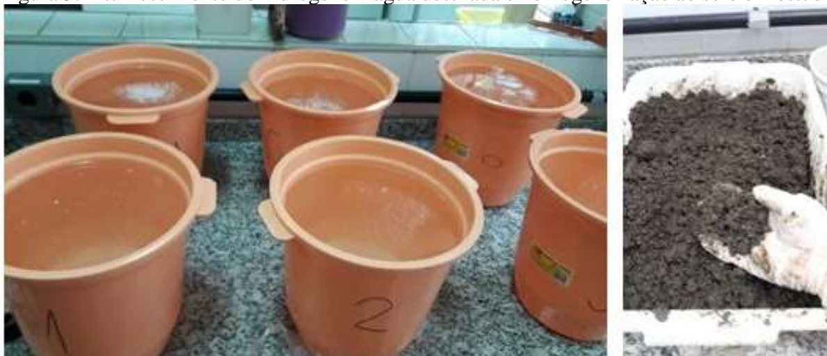
Figura 5. Intumescimento do hidrogel em água destilada e homogeneização ao solo em estudo.
