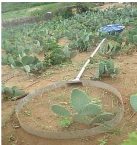
Figura 8. Parcela de erosão instalada em uma das áreas de estudo.
