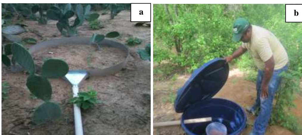
Figura 7. Parcelas de erosão de 1m 2 (a) e coletor de sedimentos (b).
