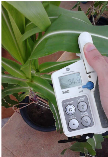
Figura 7 - Determinação do teor relativo de clorofila nas folhas de milho com clorofilômetro.
