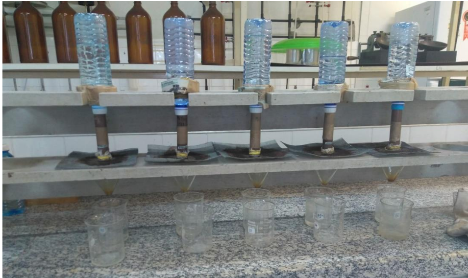
Figura 3: Condutividade hidráulica do solo saturado, método do permeâmetro de carga constante, com adaptação devido ao tamanho dos cilindros utilizados.
