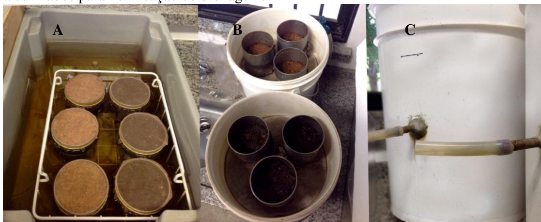
Figura 9: Sistema para determinação da capacidade de retenção de água ou microporosidade dos substratos. Saturação dos substratos (A), amostras sob tensão de 10 c.c.a (B), baldes com areia utilizados para verificação de drenagem.
