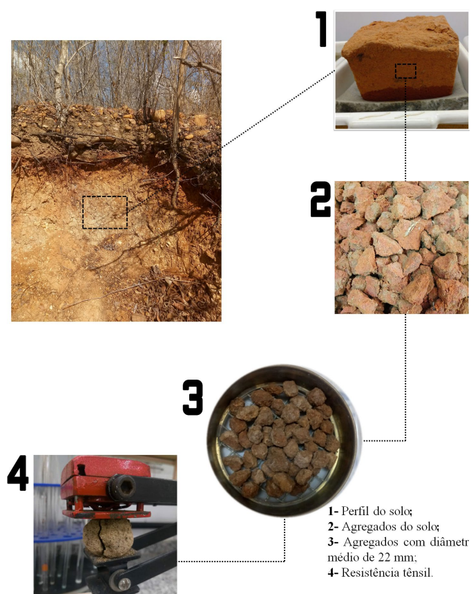
Figura 2. Etapas realizadas na coleta e preparo dos agregados para determinação da resistência tênsil.
