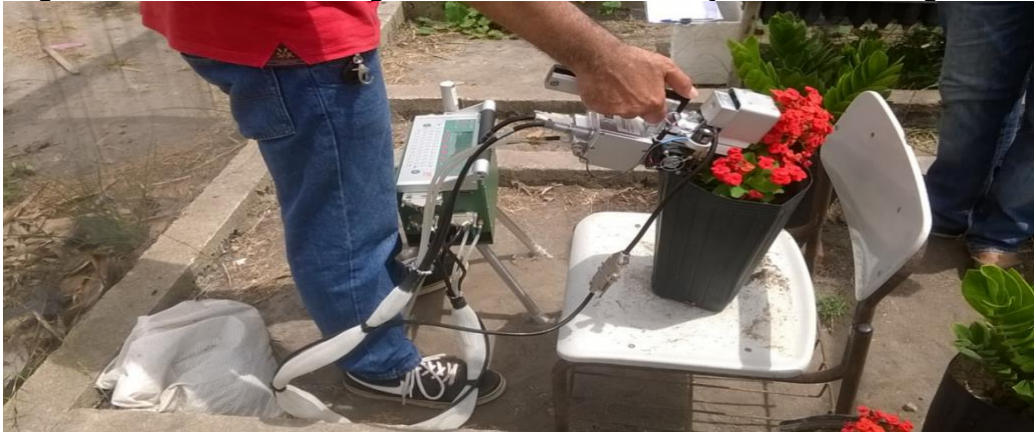
Figura 6 – Analisador de gases – IRGA na avaliação das trocas gasosas
