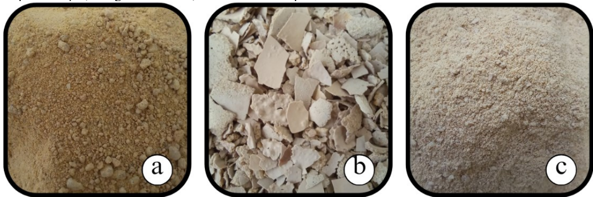
Figura 4: Em a) o material antes da extração de amorfos, b) solo após extração e secagem em estufa e c) solo após extração, secagem em estufa, destorroamento e peneiramento em tamis de malha de 2 mm de abertura.
