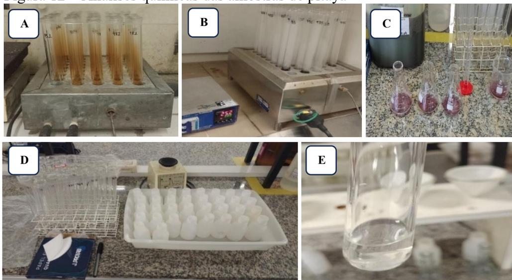
Fonte: Autor. Legenda: A) Digestão sulfúrica inicial; B) Digestão sulfúrica final; C) Titulação após digestão nítrica-perclórica; D) Amostras e materiais para filtragem da solução; E) Amostras pronta para filtragem.
